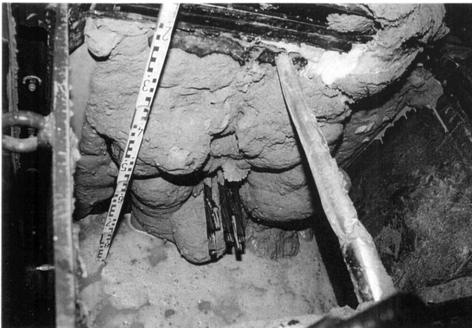
Bild 8: Gelschleierausbildung an der Kasteninnenwand, rechts oben reines Gel
